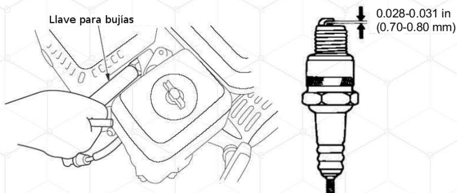
3. Inspeccione la bujía, reemplácela si los electrodos se encuentran gastados, o si el aislante esta roto o golpeado.
